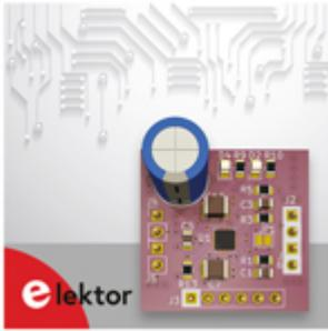
**Driver motore da 5A** Realizziamo una scheda driver per motori a corrente continua (DC) da 5A.
