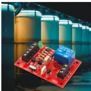
**Stabilizzatore di livello liquidi** Attraverso i contatti di un relé e di un doppio deviatore consente di mantenere il livello del liquido contenuto in una vasca o serbatoio al valore desiderato, intervenendo su una pompa o elettrovalvola.
