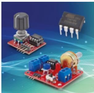
**Breakout con ATtiny85** Scopri il potenziale del microcontrollore ATtiny85 in applicazioni pratiche come la gestione di encoder rotativi e PID, sfruttando l'efficiente collegamento I2C.
