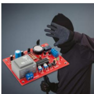
**Monitor allarme di assenza rete elettrica** Scoraggiamo i malintenzionati che ci staccano la corrente, con un dispositivo che attiva l'allarme se manca la tensione di rete per più di qualche secondo, con conteggio degli eventi occorsi.
