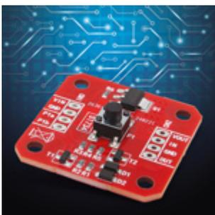
**Latch di alimentazione** Permette di alimentare circuiti elettronici con la semplice pressione di un pulsante, intervenendo direttamente sull'alimentazione principale e consumando nulla quando è a riposo.
