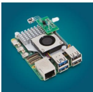
**Telecomando universale AI MediaPipe PER TV** Realizziamo un dispositivo basato su Raspberry Pi capace di riconoscere gesti predefiniti della mano ed associarli a comandi ad infrarosso.
