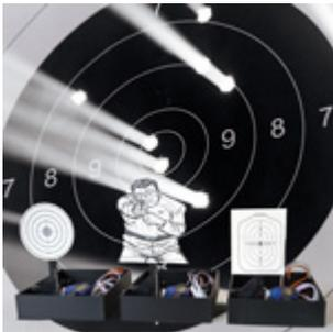
**Smart Target** Realizziamo bersagli avanzati, interconnessi in una rete, ideali per competizioni con pistole giocattolo. L'intero sistema è facilmente gestibile tramite smartphone, grazie all'integrazione del modulo ESP32.
