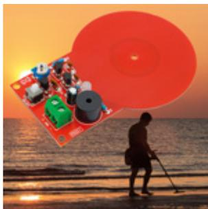
**Mini metal detector** Cercametalli di piccole dimensioni ideale sia per ritrovare monete e oggetti metallici nella terra e nella sabbia, sia per rilevare corpi metallici nei vestiti e nelle borse o tubi di ferro nei muri fino a 6 cm.
