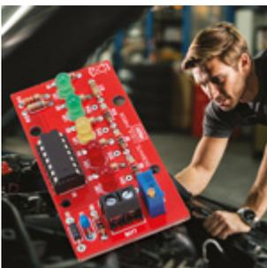
**Indicatore stato batteria** Collegato all’impianto elettrico, visualizza tramite una barra di 5 LED la tensione dell’accumulatore di bordo.
