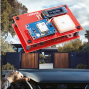
**Apricancello automatico** Abbinato a un trasmettitore radio, per mezzo della geolocalizzazione, consente l’apertura automatica del cancello quando l’auto è in prossimità della propria abitazione.
