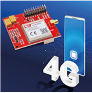
**Modulo 4G in miniatura** Implementa la connessione cellulare in banda LTE, sia per le telefonate che per l'accesso a Internet a banda larga.
