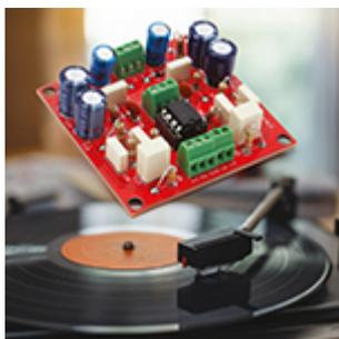
**Preamplificatore RIAA low cost per giradischi** Dispositivo che ripristina l'equalizzazione RIAA, compensando basse e alte frequenze, fra giradischi con testine a magnete mobile e amplificatore audio senza ingresso phono.
