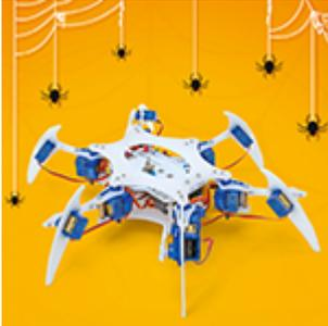
**Hexapod con ESP32** Realizziamo un robot esapode ispirato ai movimenti di un ragno. Utilizziamo una scheda ESP32 per gestire i 18 servomotori e ne programmiamo il firmware. Il controllo può avvenire da PC o smartphone via Bluetooth.
