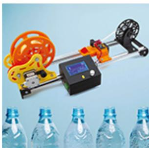
**PET filament maker** Creiamo dei filamenti per stampa 3D partendo dalle bottiglie di polietilene trasparente e colorato dell'acqua minerale e delle bevande.
