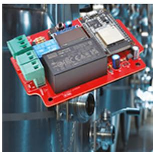
**Pump Control** Gestisce in autonomia una pompa per lo svuotamento di liquidi da pozzetti e cisterne di raccolta dell'acqua piovana, attivandola automaticamente in base ai livelli rilevati.
