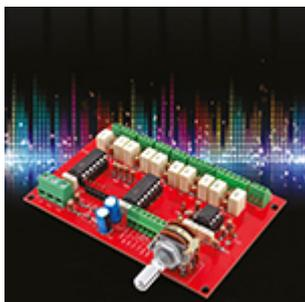
**Selettore di ingressi BF con volume** Permette di selezionare una delle quattro sorgenti audio stereo disponibili e di inviare il segnale a due uscite dedicate: una per la registrazione e l'altra, dotata di controllo del volume, per l'amplificazione.
