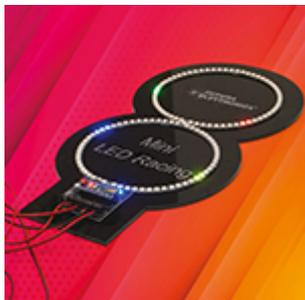
**Mini LED racing** Gioco elettronico di abilità dove quattro giocatori, tramite pulsanti, avanzano un punto luminoso lungo un circuito virtuale a otto, formato da LED RGB NeoPixel.
