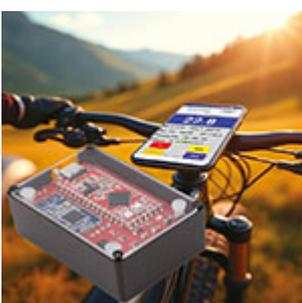
**Tachimetro per bicicletta con Nano R4** Tachimetro per bicicletta, basato su board Futura Nano R4, che misura velocità, distanza e tempo tramite sensore Hall, BLE HM10 e App per trasferire le informazioni ad un cellulare.
