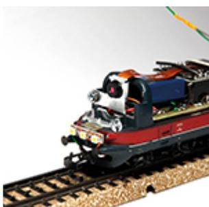
**Sistema di monitoraggio per plastico ferroviario con telecamera** Migliora il tuo plastico ferroviario utilizzando il modulo ESP32-CAM. Questa guida ti guiderà passo dopo passo nell'installazione di una telecamera sulla tua locomotiva, nella creazione di una scheda di base personalizzata per l'alimentazione e nella configurazione del software essenziale.
