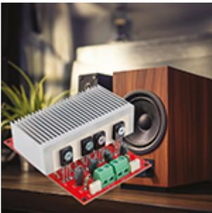
**Amplificatore BF ibrido stereo** Amplificatore economico, basato su operazionali, funzionante in stereo o mono a ponte. Eroga circa 2 + 2 W; ideale per piccoli sistemi hi-fi domestici.
