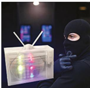
**TV simulator** Tramite una matrice di LED RGB produce lampi di luce colorati che dall'esterno danno la sensazione che in casa ci sia qualcuno che sta guardando la TV.
