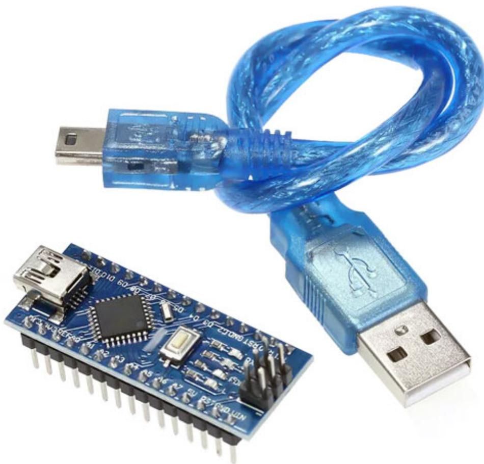
AC004 è una scheda elettronica compatibile con Arduino Nano e basata sul microcontrollore Atmega328. Dispone di memoria Flash da 32 kB (di cui 2 kB utilizzati dal bootloader), 14 ingressi/uscite digitali (di cui 6 possono essere utilizzati come uscite PWM), 8 ingressi analogici, un oscillatore a 16 MHz e viene programmata attraverso un cavo USB mini (compreso).
