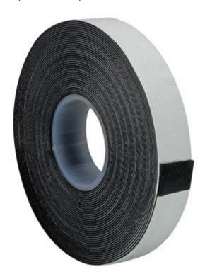
Speciale nastro di gomma autovulcanizzante di colore nero non adesivo. Avvolto su se stesso forma una massa compatta con effetto fusione, impermeabile all'acqua, che permette di ripristinare giunture di tubi e manicotti. Lunghezza 9 m; larghezza 19 mm, spessore 0,76 mm.
