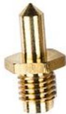
Nozzle in ottone con foro di estrusione diametro 0,35 mm, adatto per sezione riscaldante della stampante 3D Vertex. Dimensioni (mm): lunghezza 20,10 x diametro max. 6,8 (parte filettata).
