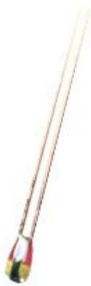
[Termistore](#) NTC da 100 kohm indicato per la misurazione di temperature fino a 300°C. È dotato di corpo in vetro resistente al calore, indice di sensibilità: 4066K, coefficiente termico: 4,5%/°C, dimensioni (mm): 1,3 diametro x 2,2, lunghezza terminali: 65 mm.
