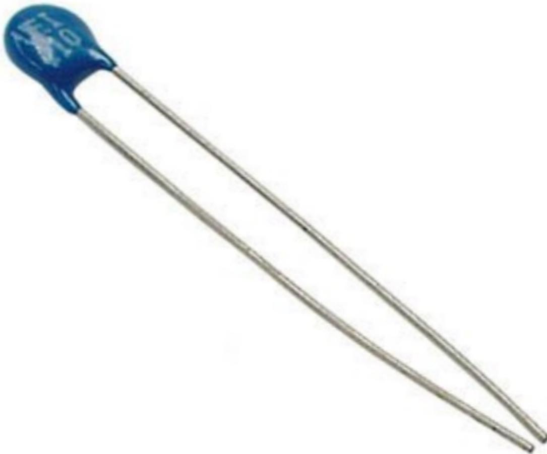
Termistore con rivestimento in resina epossidica; resistenza nominale 5 kohm; costante B (~7%) 4100°K; costante di dissipazione termica 6 mW/°C; corrente massima 45 mA; costante di tempo termica 15 s; dimensioni Ø 5 mm.
