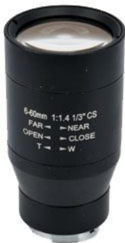
Obiettivo per CCTV con focale regolabile tra 6 e 60 mm; regolazione manuale dell'apertura del diaframma. L'obiettivo è adatto per telecamere con attacco CS con sensore da 1/3".
