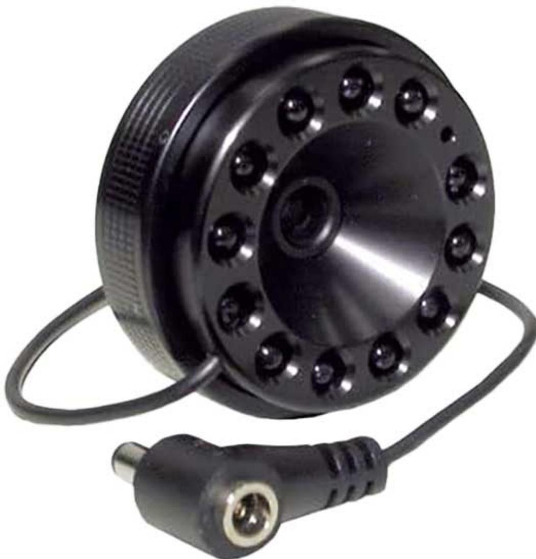
I LED IR si attivano automaticamente al di sotto di una certa soglia luminosa. Compatibile con sensori da 1/3" e 1/4" sia a colori che in bianco e nero. L'obiettivo preleva la tensione di alimentazione tramite connessione al plug 12 Vdc della telecamera. Adatto per telecamere con attacco CS.
