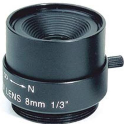
Obiettivo per CCTV con diaframma fisso (F1.6) e focale di 8,0 mm adatto per telecamere con attacco C sia con sensore da 1/3" che da 1/4". L'obiettivo va fissato alla telecamera interponendo l'anello di prolunga.
