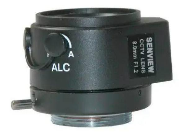
Obiettivo per CCTV con focale fissa da 8 mm e controllo auto-IRIS di tipo Video Drive. Perni di blocco delle impostazioni. L'obiettivo è adatto per telecamere con attacco CS sia con sensore da 1/3" che da 1/4".
