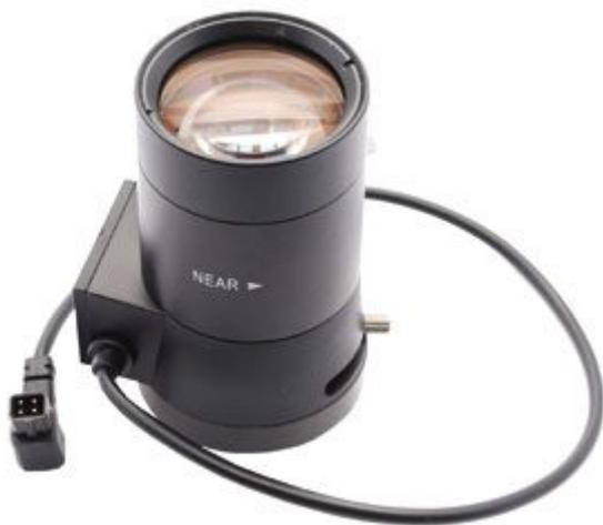
Obiettivo per CCTV con focale regolabile tra 6 e 60 mm. Auto-IRIS con controllo di tipo DC. Regolazione messa a fuoco con perni di blocco delle impostazioni. L'obiettivo è adatto per telecamere con attacco CS
