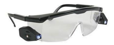
Occhiali protettivi conformi allo standard EN166:2002. Dispongono di luce orientabile con LED ultra luminosi, interruttore ON/OFF e stecche allungabili. Peso 54 grammi, alimentazione 2 batterie CR2032 per ogni LED (incluse).
