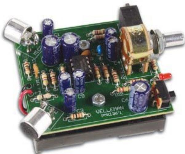
Amplificatore stereo in grado di amplificare il suono 50 volte. Ideale per persone con difficoltà di udito (p.e. guardando la televisione), come gadget, per progetti, ecc... Con controllo del volume, interruttore acceso/spento e uscita jack 3,5mm per cuffie.
