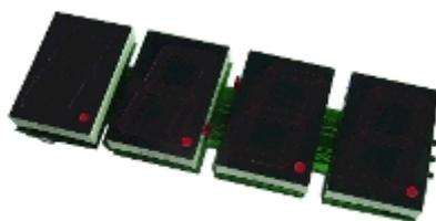
Orologio digitale composto da quattro display giganti a 7 segmenti. Oltre alla visualizzazione dell'orario è in grado di visualizzare in sequenza - in maniera automatica - le scritte "OPEN", "CLOSED" e la temperatura. Per visualizzare la temperatura è necessario acquistare separatamente il sensore di temperatura 8220-K8067 (versione in kit) o 8220-VM132 (versione montata).
