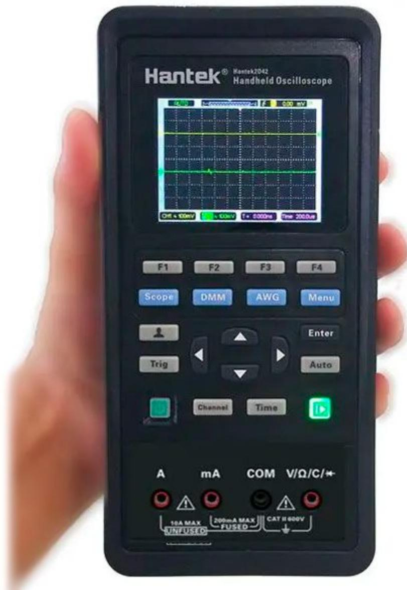
Oscilloscopio digitale portatile a due canali con generatore di funzioni/forme d'onda arbitrarie fino a 25 MHz con 12 bit di risoluzione (dopo ogni ricarica di 2 ore, il dispositivo può essere utilizzato continuamente per un'intera giornata o in standby per più di 24 ore).
