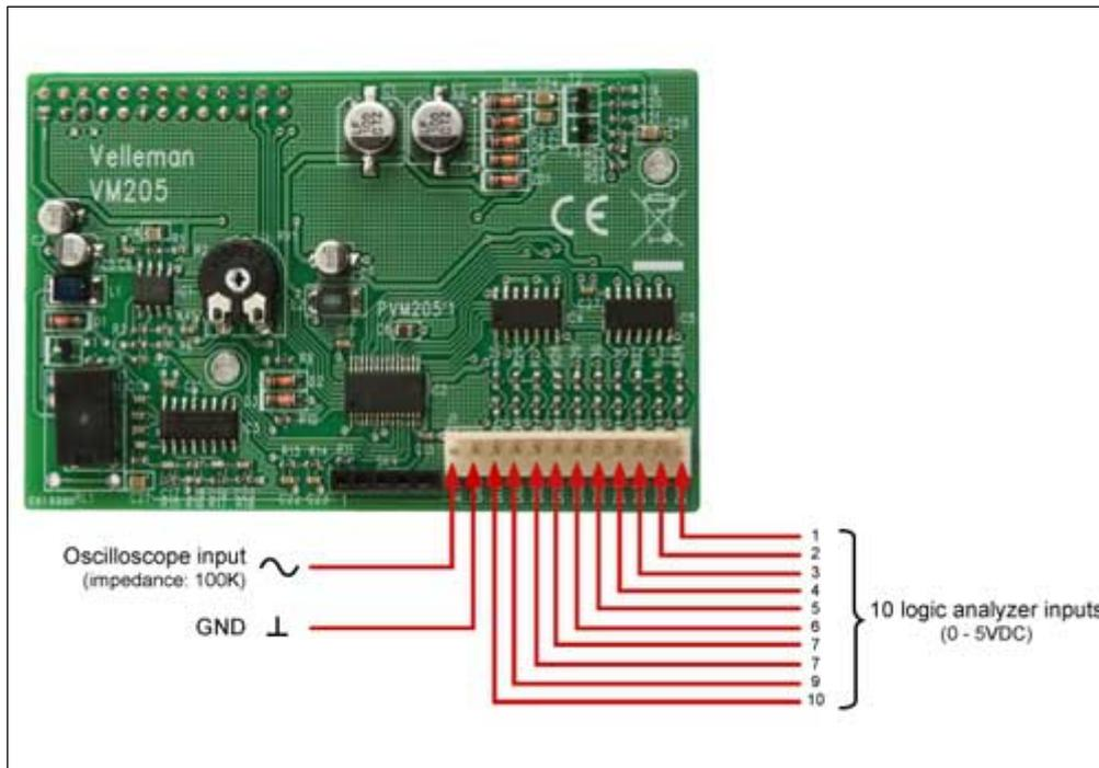
Grazie a questo shield, abbinato a Raspberry Pi (non incluso), potrete avere a disposizione un oscilloscopio e un analizzatore logico a 10 canali. Viene fornito anche il codice sorgente che permette di sviluppare le proprie applicazioni.
