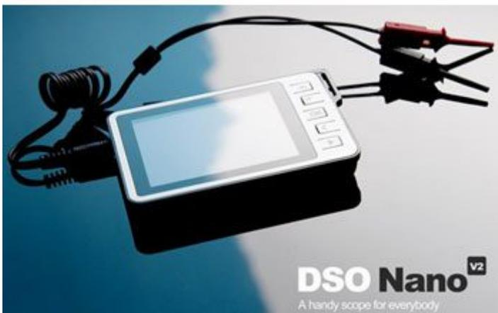
Seconda versione dell'oscilloscopio tascabile basato su processore ARM [Cortex](#)
