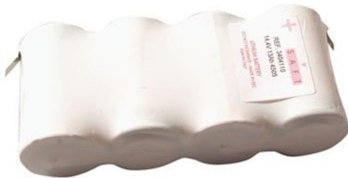
Pacco batterie al litio in formato "D" composto da 4 elementi per una capacità complessiva di 13000 mAh/14,4V. Ideale per applicazione telecom in virtù della elevatissima corrente di spunto e della particolare curva di scarica.
