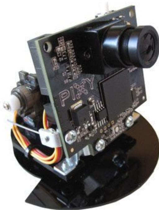
Confezione contenente tutto il necessario (meccanica e due microservi RC) per realizzare il Pan/tilt da utilizzare con la telecamera PIXY (non compresa).
