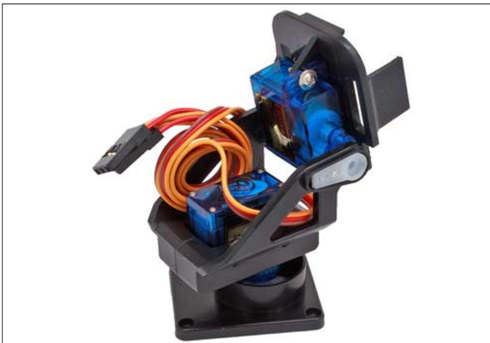
Set per realizzare un sistema Pan/Tilt con servo RC da 9 grammi con dimensioni (mm): 22x12x29. Attenzione! la confezione non comprende i servi RC.
