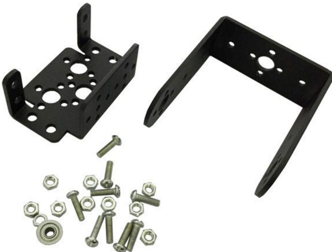
Staffa Pan/Tilt per mini telecamere, sensori infrarossi, ultrasuoni o altro. Può essere utilizzata con i servo RC (7300-SERVO209 e tutti i servo con dimensioni: 40x20x38 mm). La confezione comprende le due staffe, viti e dadi per il fissaggio. Materiale: alluminio spesso 2 mm, colore: nero, dimensioni (mm): 58X37X25,5, peso: 51,2 grammi. **Attenzione!** i servo RC non sono compresi (vedere prodotti correlati).
