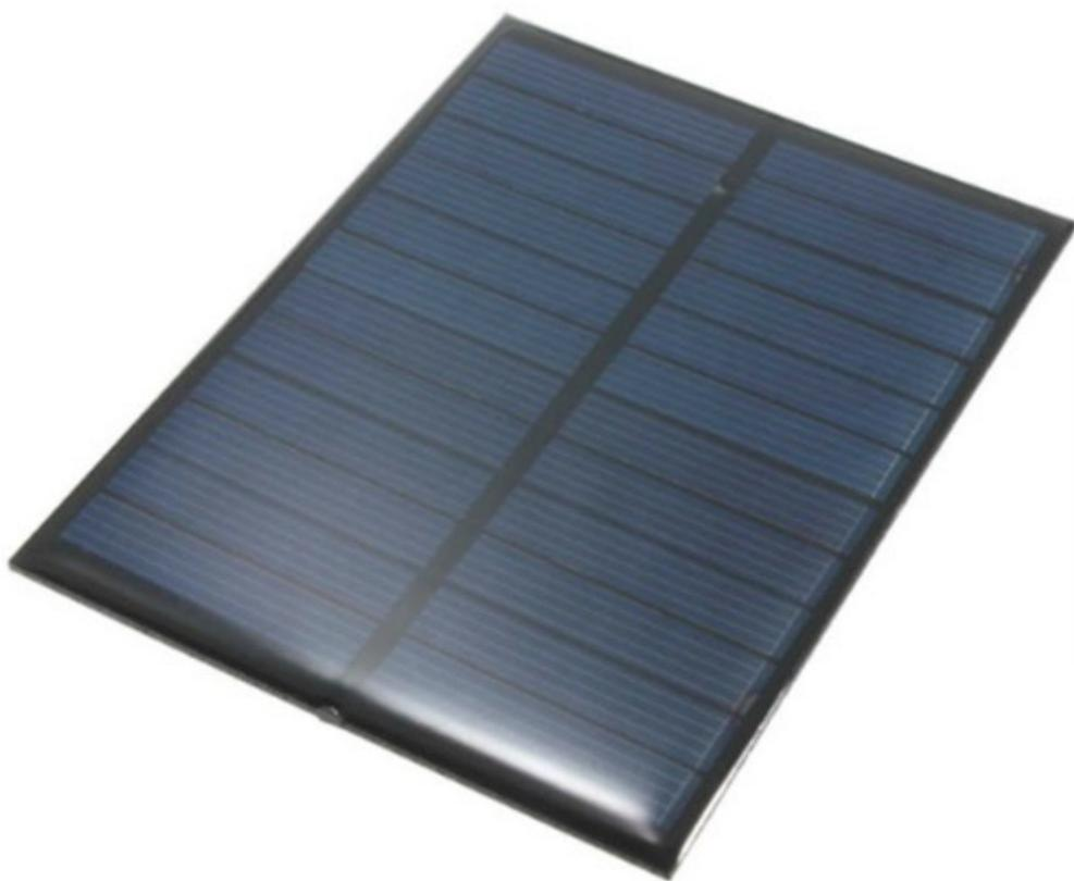
Pannello fotovoltaico monocristallino dalle dimensioni contenute e dall'elevata efficienza d'uscita, ideale per la ricarica di batterie, smartphone, robotica, ecc... Tensione di uscita: 6 volt, potenza: 1,1 watt, corrente: 183 mA, dimensioni (mm): 102x83x2, peso: 32 grammi.
