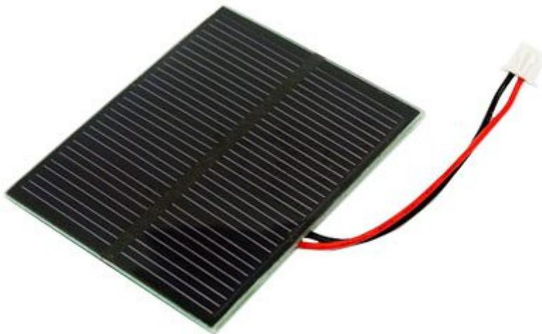
Pannellino fotovoltaico dalle dimensioni estremamente ridotte, ideale per effettuare esperimenti con l'energia solare. Tensione di uscita: 5,5 V, corrente tipica: 100 mA, dimensioni (mm): 70x55x3, cavetto con connettore JST passo 2 mm.
