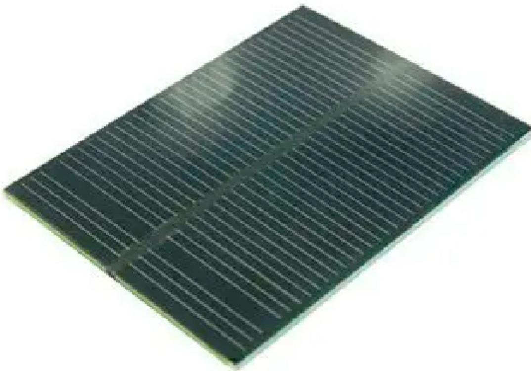
Pannellino fotovoltaico dalle dimensioni estremamente ridotte, ideale per effettuare esperimenti con l'energia solare. Tensione di uscita: 5,5 V, corrente massima: 170 mA, collegamento: cavetto rosso-nero con connettore JST, dimensioni (mm): 100x75x2,9.
