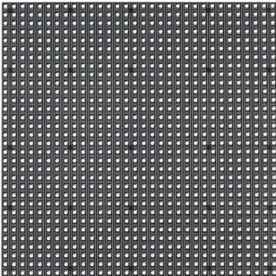
Abbinato ad Arduino, Raspberry o altro microcontrollore, questo pannello dotato di 1024 LED RGB (32x32), permette di creare animazioni, scritte, disegni, ecc. Dispone di due connettori IDC, uno come input e l'altro come output che permette di collegare più pannelli in cascata per formare schermi ancora più grandi. Alimentazione: 3,3 V - 5 V / 2A. La confezione comprende il pannello a LED, il cavo di alimentazione e un cavo flat con connettori IDC a 16 pin (2x8). Dimensioni (mm): 193x193x14.
