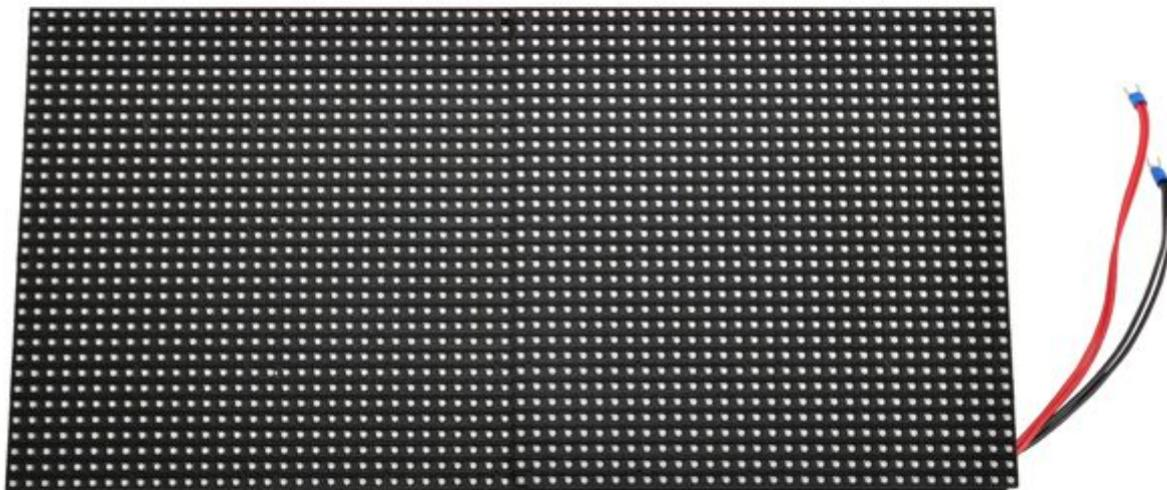
Abbinato ad Arduino, Raspberry o altro microcontrollore, questo pannello dotato di 2048 LED RGB (64x32), permette di creare animazioni, scritte, disegni, ecc. Dispone di due connettori IDC, uno come input e l'altro come output che permette di collegare più pannelli in cascata per formare schermi ancora più grandi. Alimentazione: da 4,7 V a 5 V / 2 A, dimensioni (mm): 384x192x14. La confezione comprende il pannello a LED, il cavo di alimentazione e un cavo flat con connettori IDC
