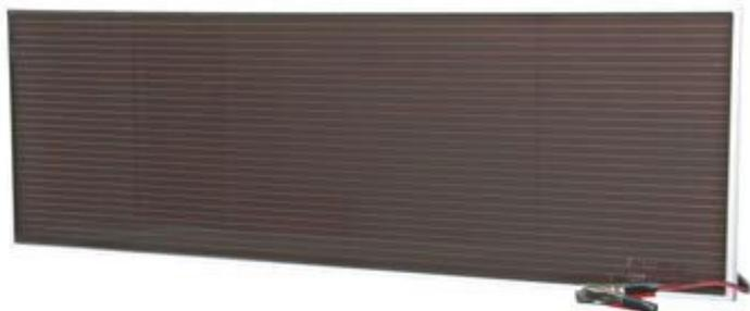
Pannello solare amorfo da 15 watt dotato di telaio in alluminio, resistente all'acqua e alla corrosione. Potenza di picco: 15 W, tensione al punto di massima potenza: 17,5 V, corrente massima: 0,85 A, dimensioni: 923 x 313 x 22 mm, peso: 4,9 kg.
