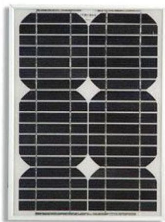
Modulo monocristallino da 15 watt dotato di telaio in alluminio e protetto da vetro temprato. Potenza di picco: 15 W, tensione al punto di massima potenza: 17,2 V, corrente massima: 0,88 A, dimensioni: 440 x 294 x 23 mm, peso: 1,8 kg.
