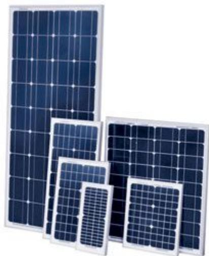
Modulo monocristallino da 24 watt dotato di telaio in alluminio e protetto da vetro temperato. Potenza di picco: 24 W, tensione al punto di massima potenza: 18 V, corrente massima: 1,38 A, dimensioni: 630 x 290 x 25 mm, peso: 3,2 kg.
