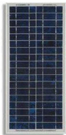
Modulo monocristallino da 24 watt dotato di telaio in alluminio e protetto da vetro temprato. Potenza di picco: 24 W, tensione al punto di massima potenza: 17,4 V, corrente massima: 1,38 A, dimensioni: 570 x 414 x 23 mm, peso: 2,5 kg.
