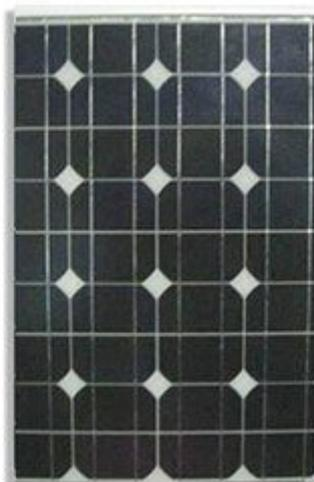
Modulo monocristallino da 85 watt dotato di telaio in alluminio e protetto da vetro temprato. Potenza di picco: 85 W, tensione al punto di massima potenza: 17,6 V, corrente massima: 4,83 A, dimensioni: 1210 x 540 x 28 mm, peso: 8,2 kg.
