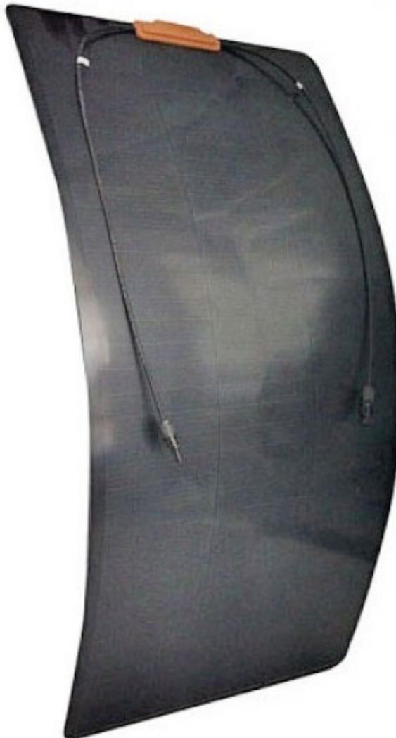
Pannello solare realizzato in silicio monocristallino. Leggero e flessibile, è progettato principalmente per essere montato su superfici leggermente curve come ad esempio, su imbarcazioni, roulotte e camper. È dotato di cavi lunghi 700mm con connettori MC4. Grado di protezione IP67, alimentazione 12V, potenza 150W .
