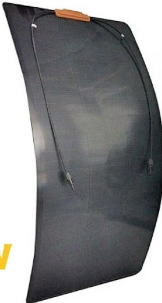
Pannello solare monocristallino semirigido ad alta efficienza, super sottile (solo 2 mm), leggero e impermeabile. Potenza di picco: 30 W, tensione al punto di massima potenza: 17,65 V, corrente massima: 1,70 A, dimensioni (mm): 570x350x2. Facile da installare, può essere impiegato per piccoli impianti solari, barche, yacht, camper, campeggio, ecc.
