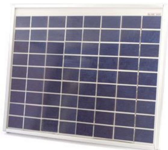
Modulo policristallino da 10 watt dotato di telaio in alluminio anodizzato e protetto da vetro temprato. Potenza di picco: 10 W, tensione al punto di massima potenza: 16,5 V, corrente massima: 0,61A, dimensioni: 38,7 x 29,3 x 2,5 cm, peso: 1,1 kg. Particolarmente indicato per impianti fissi.
