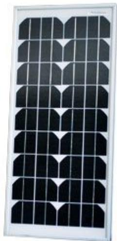
Modulo policristallino da 20 watt dotato di telaio in alluminio anodizzato e protetto da vetro temprato. Potenza di picco: 20 W, tensione al punto di massima potenza: 16,5 V, corrente massima: 1,21 A, dimensioni: 50 x 36 x 3,5 cm, peso: 2 kg. Particolarmente indicato per impianti fissi.
