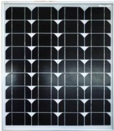
Modulo policristallino da 30 watt dotato di telaio in alluminio anodizzato e protetto da vetro temprato. Potenza di picco: 30 W, tensione al punto di massima potenza: 17,40 V, corrente massima: 1,75 A, dimensioni: 66,5 x 42,1 x 2,5 cm, peso: 3,9 kg. Particolarmente indicato per impianti fissi.
