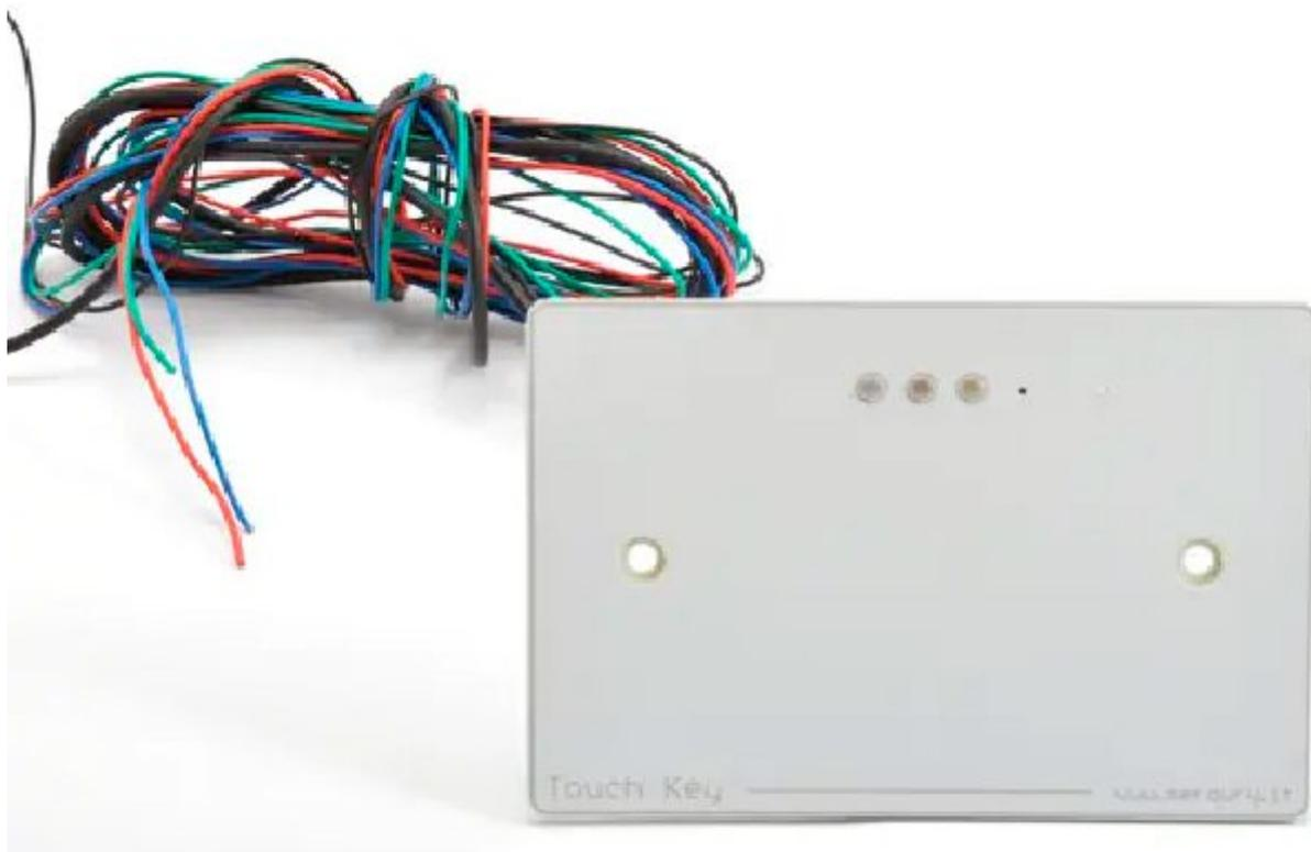
Pannello touch con 3 LED di stato (rosso-blu-verde) per sistema Touch Key. Compatibile con scatole da incasso esterne a 3 moduli. Dimensioni (mm): 118x80x2,5, lunghezza cavi: 1 metro, grado di protezione: IP64.
