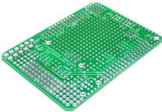
Circuito stampato multifori (58,50 x 82,70 mm) utilizzato per la prototipazione con le schede Arduino. Può anche essere utilizzato come semplice piastra sperimentale.
