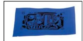
**5** Pulire accuratamente la basetta ramata con dell'alcool.
