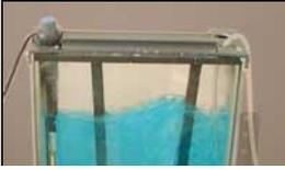
**9** Immergere la basetta nell'acido per corrodere il rame in eccesso.
