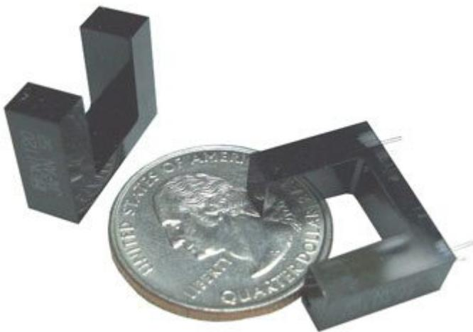
Interruttore ottico a forcella costituito da un diodo emettitore a infrarossi e da un fototransistor utilizzato come elemento di rivelazione della luce. I due elementi sono disposti uno di fronte all'altro, quando un oggetto passa tra di essi il fascio viene interrotto.
