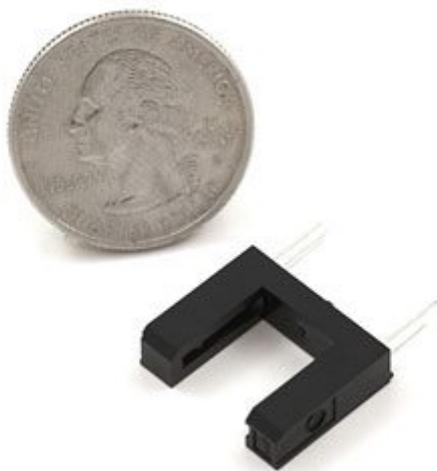
Interruttore ottico a forcella costituito da un diodo emettitore a infrarossi e da un fotodiode utilizzato come elemento di rivelazione della luce. I due elementi sono disposti uno di fronte all'altro, quando un oggetto passa tra di essi il fascio viene interrotto. Dimensioni: 18,6 x 15,2 x 5 mm. Utilizzato come finecorsa ottico, rilevatore di oggetti, ecc.
