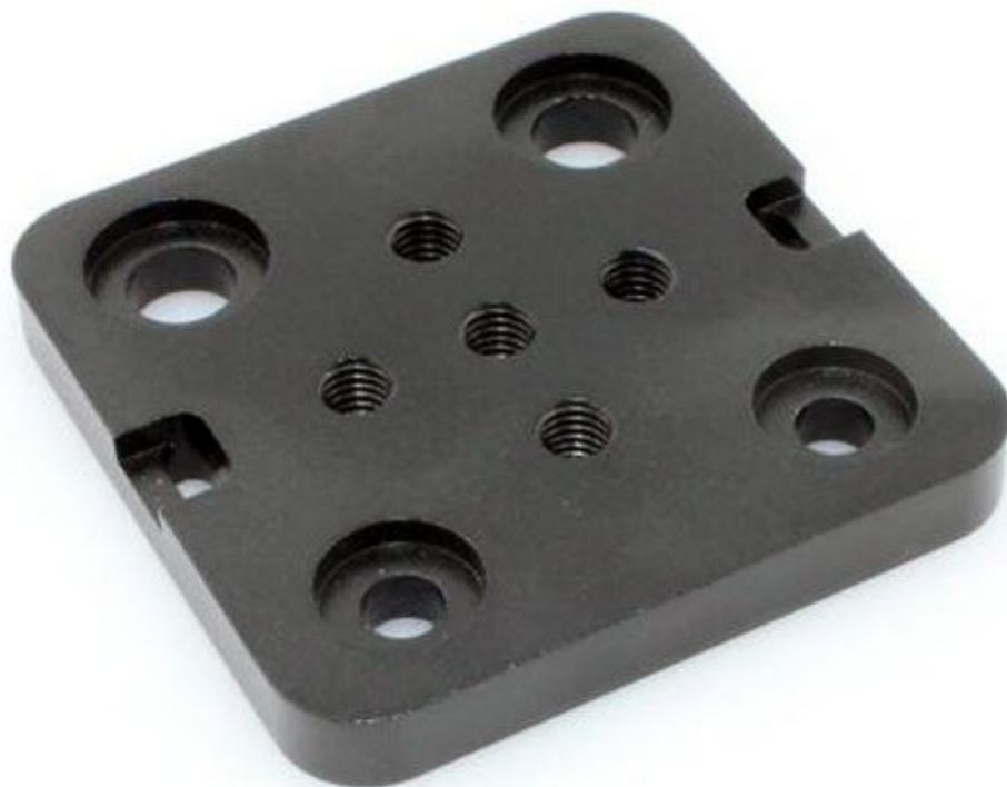
Piastra in alluminio da 6 mm di spessore adatta per la realizzazioni di carrelli per movimentazione lineare con mini pulegge OpenBuilds. Dispone di 5 fori centrali con filettatura M5 e di 4 esterni per il fissaggio dei perni porta pulegge (2 con diametro idoneo al montaggio di eccentrico).
