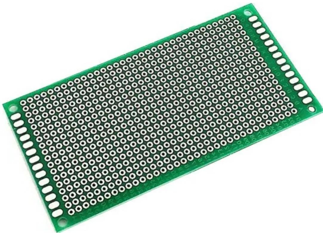
Piastra millefori mono faccia con piazzola a un foro, distanza tra le piazzole: 2,54 mm, diametro foro: 1 mm, materiale: fibra di vetro, dimensioni (mm): 100x50x1,6.
