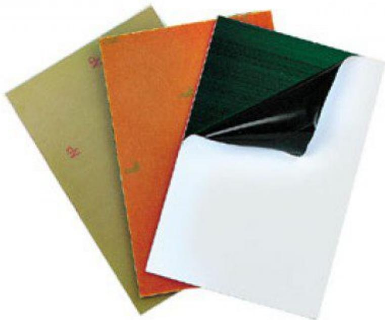
Piastra in vetronite dello spessore di 1,6 mm ricoperte da uno strato uniforme di rame da 35 micron e fotoresist. Singola faccia. Dimensioni 100 x 160 mm.
